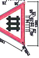
(T-25) KONTROLÜ DEMİRYOLU GEÇİDİ
